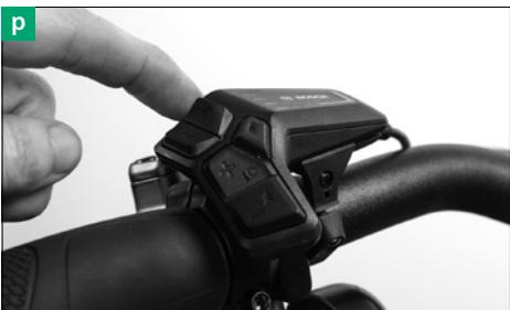
[n] Los LED de la unidad de mando indican la actividad de carga, el estado de carga de la batería y posibles mensajes de error. El tiempo necesario de carga depende de la carga restante en la batería y de la temperatura ambiente.
