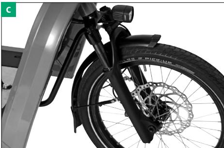
9. Su bicicleta VELO DE VILLE FR8 está equipada con una horquilla de suspensión **[c]**. Deje en manos de distribuidor VELO DE VILLE el ajuste de la horquilla de suspensión. Un ajuste incorrecto de la horquilla de suspensión puede provocar anomalías funcionales o causar daños al componente. En cualquier caso, esto afectará el comportamiento de marcha de la bicicleta y usted no obtendrá la máxima seguridad y placer de conducción.
